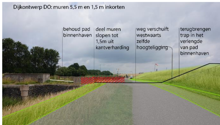
Afbeelding 2.12 Gekozen inpassing sluishoofd waarbij muren worden
