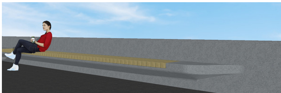
Bank geïntegreerd in de kruinmuur
