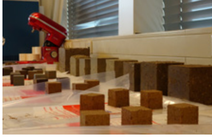
In het laboratorium zoeken we uit wat de beste samenstelling van de blokken is. We gebruiken hiervoor kleinere blokjes.
