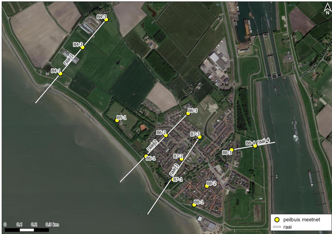
Afbeelding 4.5 Overzicht meetraaien en peilbuizen Hansweert
