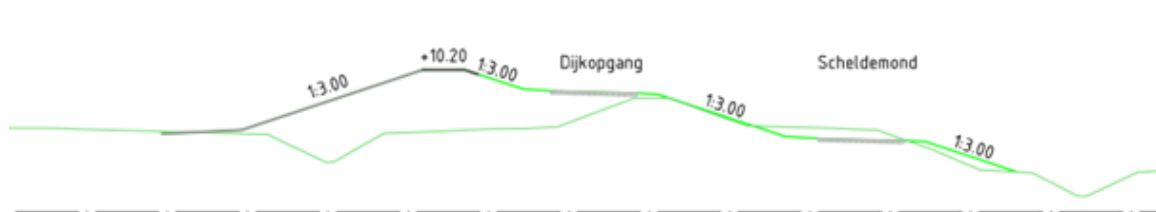
Afbeelding 2.15 Dwarsprofiel Slibdepot, met buitendijks de Voorhaven en binnendijks de Scheldemond
