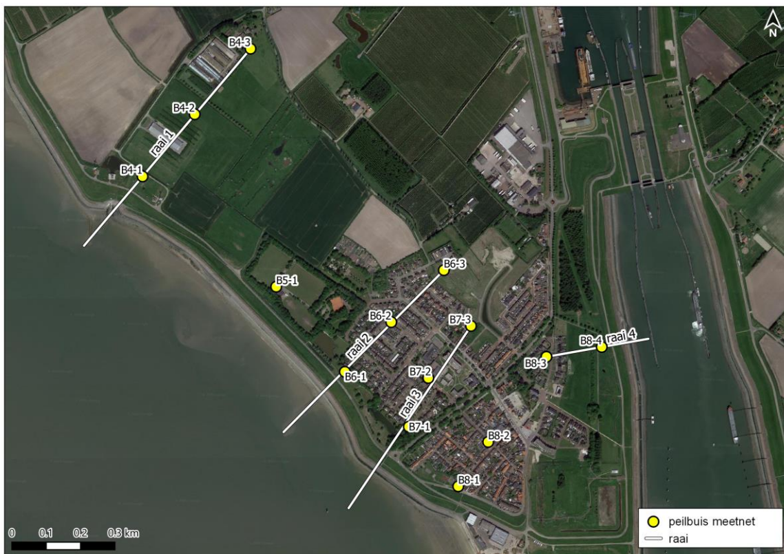
Afbeelding 4.5 Overzicht meetraaien en peilbuizen Hansweert
